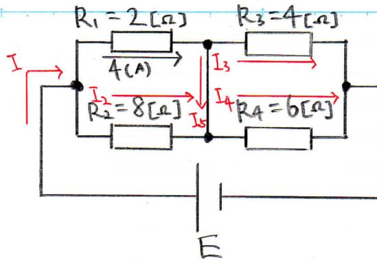
図のように抵抗  $R_2, R_3, R_4$ , 真ん中, 全体を流れる電流を  $I_2, I_3, I_4, I_5, I$  とすると、キルヒホッフの第一法則から
